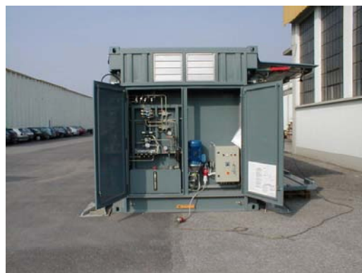
Particolare della centralina oleodinamica
