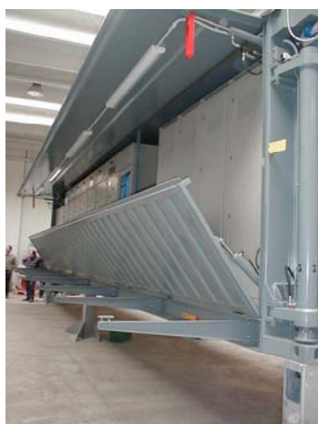
Operazioni di montaggio: apertura dei portelloni laterali
